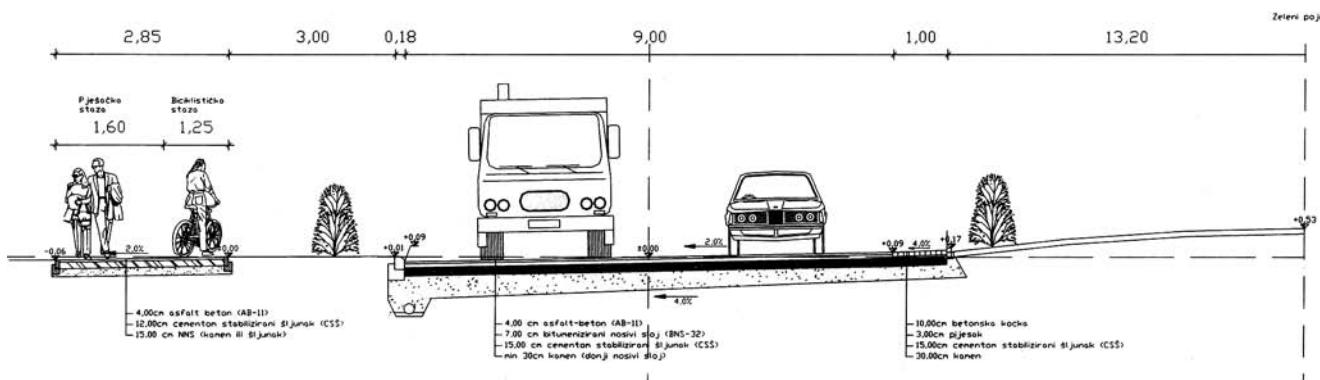
Slika 4. Poprečni presjek do središnje osi kružnog raskrižja
