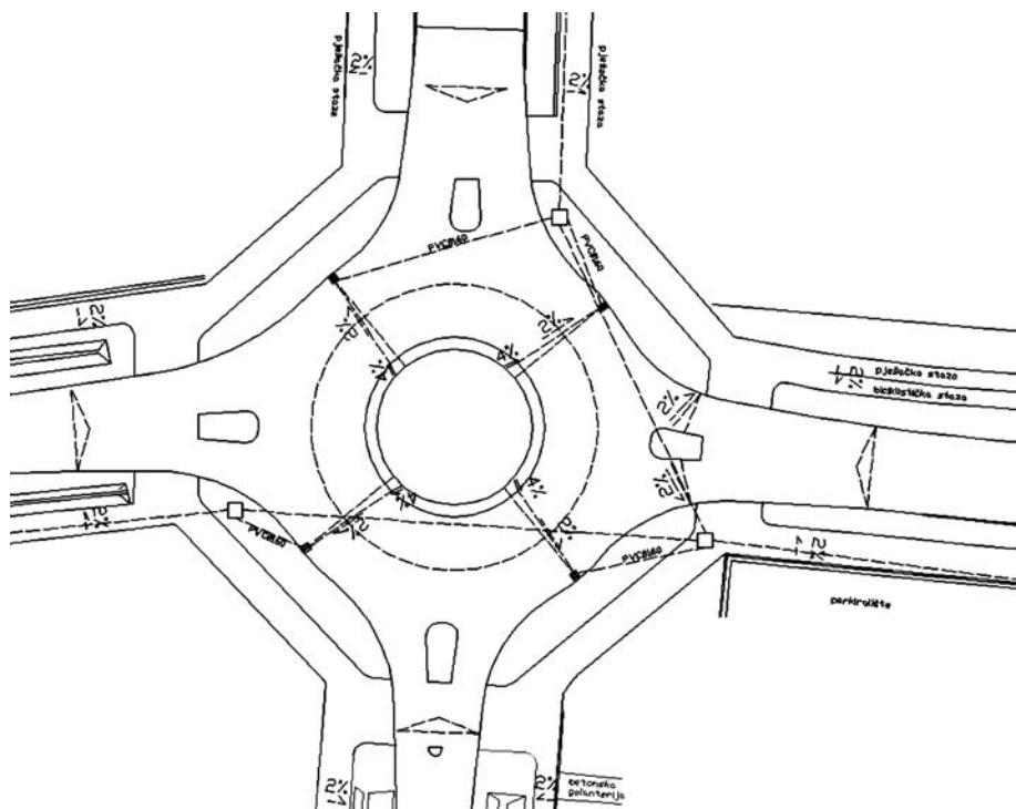
*Slika 3. Idejno rješenje odvodnje kružnog raskrižja
