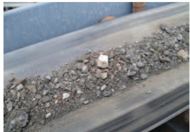
Slika 7. Reciklirani asfalt dobiven glodanjem bitumeniziranog nosivog sloja
