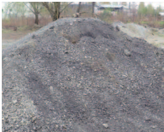
Slika 1. Deponirani reciklirani asfalt
