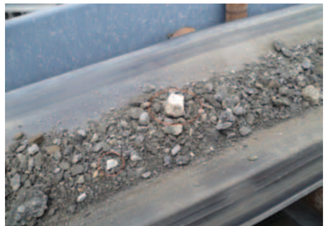
Slika 7. Reciklirani asfalt dobiven glodanjem bitumeniziranog nosivog sloja
