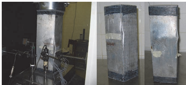
Slika 6. Ispitivanje (lijevo) i način sloma (desno) aluminijskih kvadratnih šupljih profila ispunjenih betonom [37]
