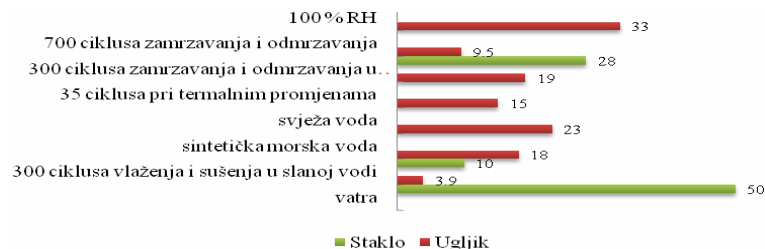
Slika 7. Degradacija vlačne čvrstoće PAV-a (%) za vanjsko ojačanje konstrukcija [8]
