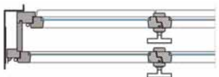
Slika 10. Horizontalni presjek dvostrukog dvokrillnog prozora
