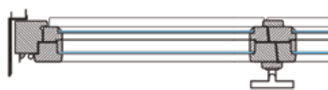
Slika 11. Horizontalni presjek spojnog dvokrillnog prozora
