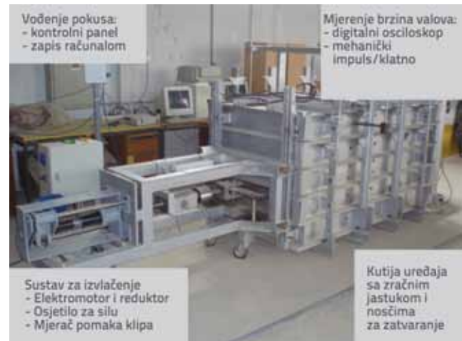
Slika 4. Veliki uređaj za izvlačenje, tip GFOS
