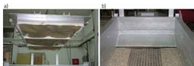
Slika 5. Uređaj za izvlačenje GFOS: a) Poklopac sa zračnim jastukom; b) košuljica za smanjenje utjecaja prednje stijenke
