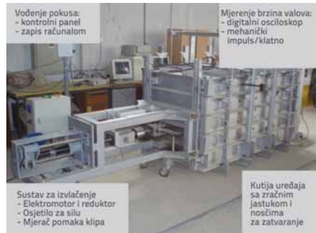
Slika 4. Veliki uređaj za izvlačenje, tip GFOS
