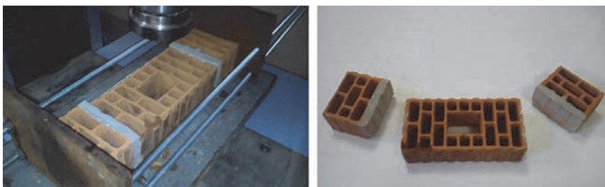
Slika 4. Posmični slom klizanjem po vertikalnim sljubnicama morta
