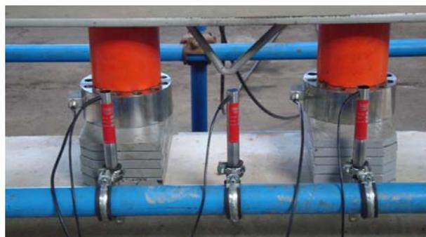
Slika 7. Mjerenje pomaka grede pri unosu opterećenja
