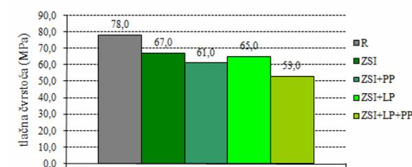
Slika 5. Tlačne čvrstoće na betonskim kockama brida 15 cm
