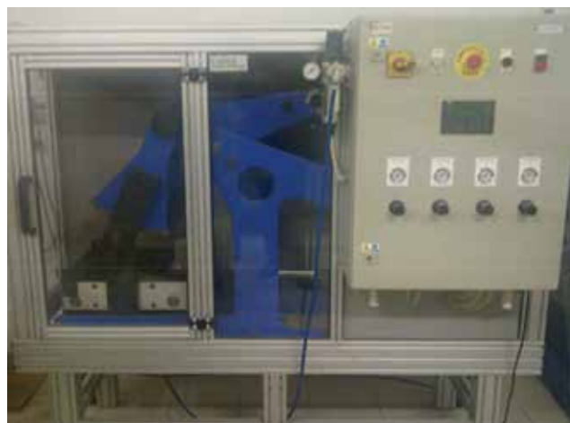
Slika 3. Valjkasti zbijajač asfaltnog sloja u kalup
