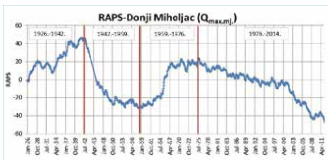
Slika 15. RAPS maksimalnih mjesečnih protoka rijeke Drave zabilježenih na postaji Donji Miholjac u razdoblju od 1926. do 2014. god.
